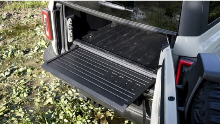
WYSUWANY STOPIEŃ POD PODŁOGĄ DRZWI BAGAŻNIKA
